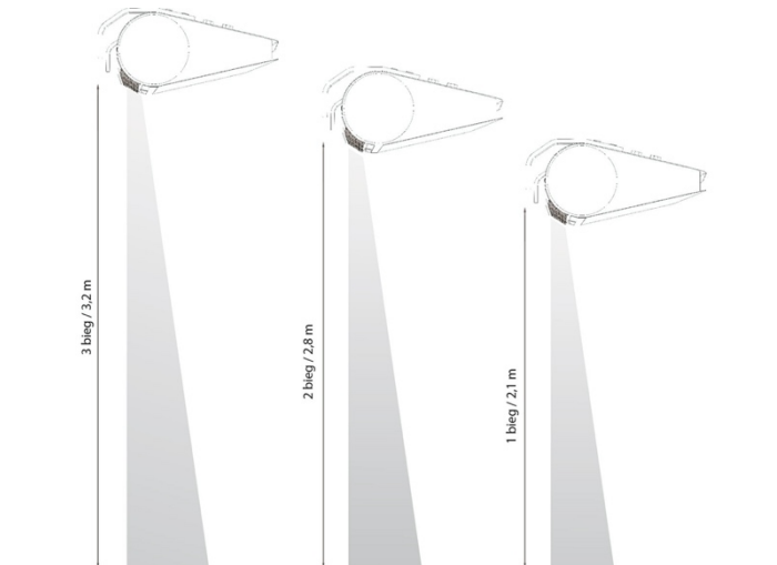
RYS. 2.2 ZASIĘG POWIETRZA NA POSZCZEGÓLNYCH BIEGACH.
